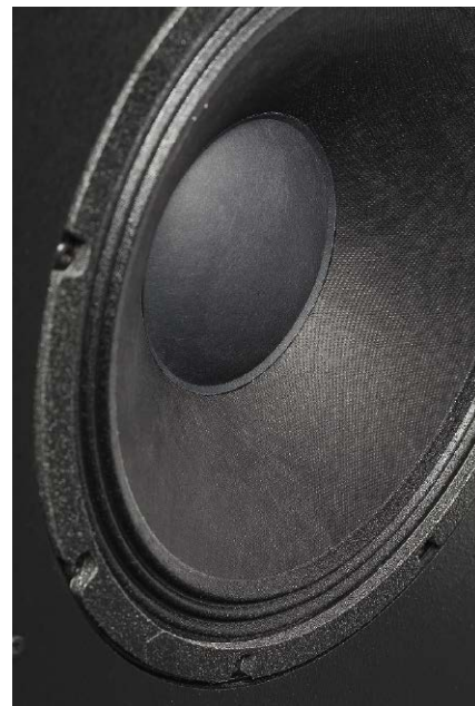
30-cm membrana niskotonowego, zawieszona tekstylnej fałdzie, wygląda na celulozową, chociaż producent przedstawia ją jako kompozytową.
